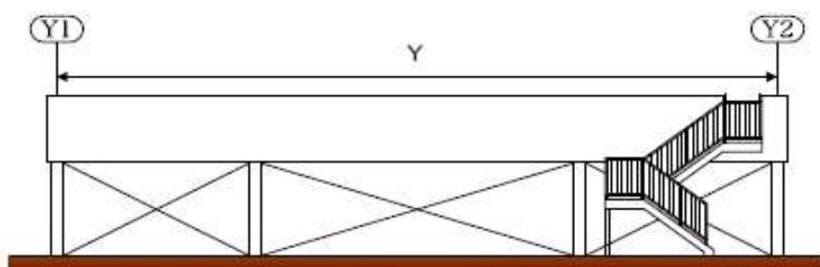
※構造上必要な柱部分及び空気の流通に支障のない階段等を除く。
