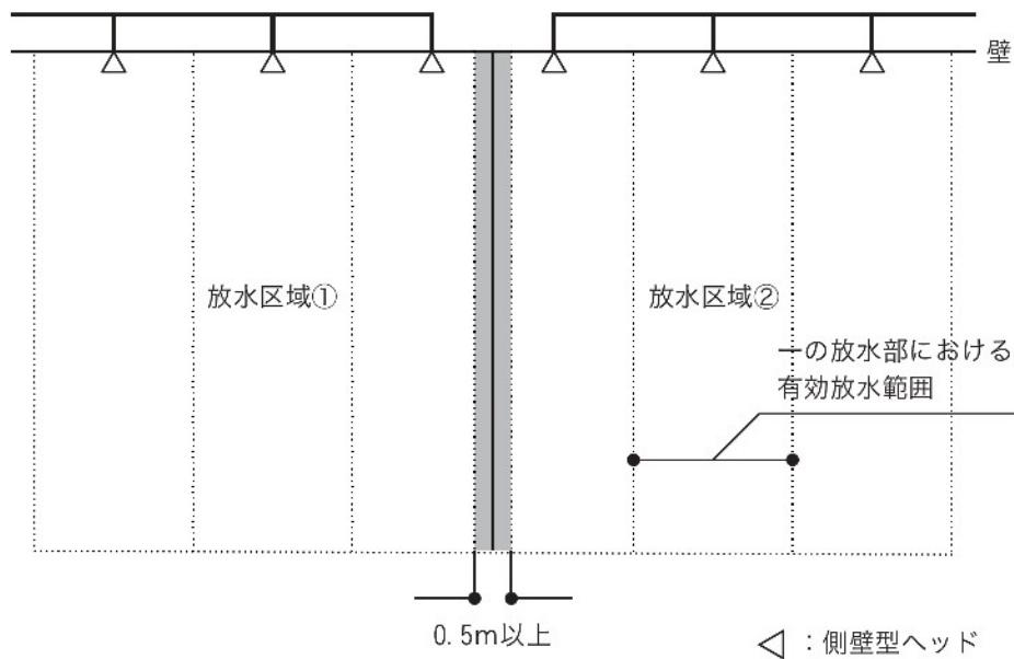
(その2) 放水区域が相互に重複する部分を、逆止弁を用いて一の固定式ヘッドで有効放水範団となるよう設ける場合
