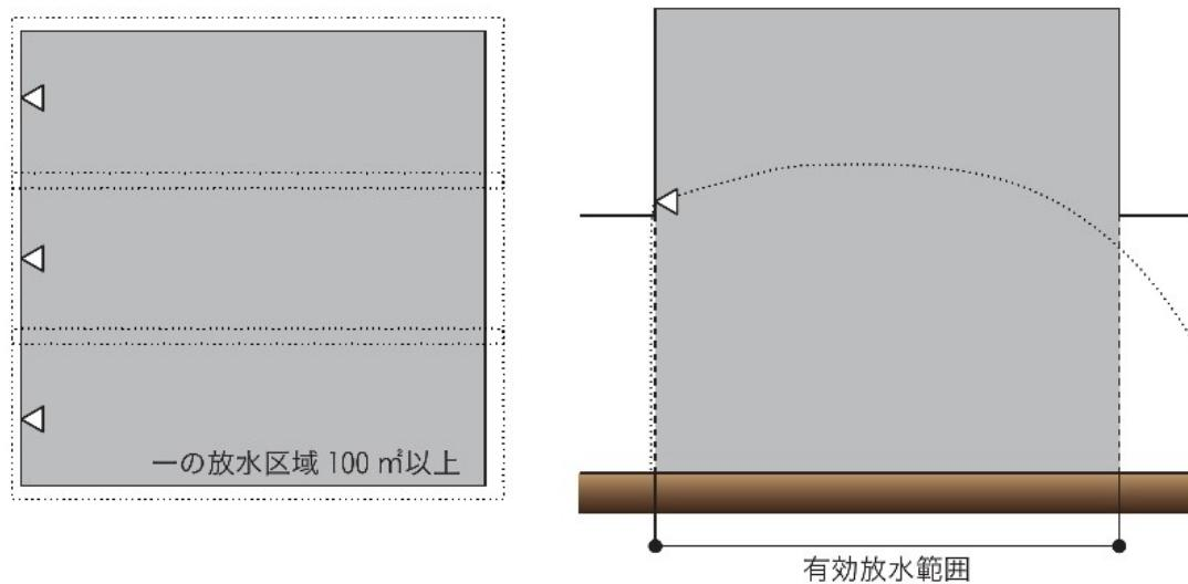
(その3) 固定式ヘッドの種類が側壁型（対列方式）の場合
