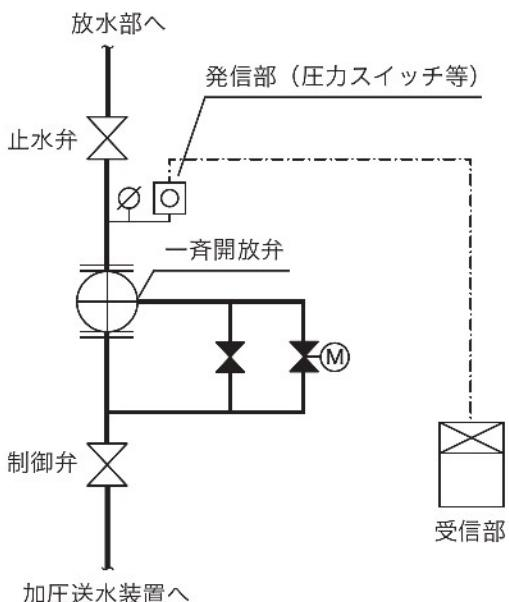
(電動弁又は電磁弁を用いる場合)
